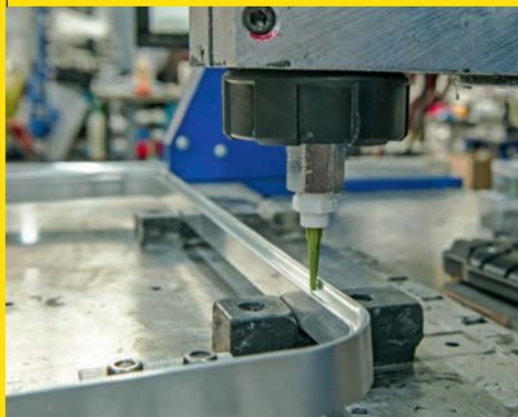
**6. Der Boden des ZEGA Evo bekommt ein Silikon-Dichtband.**
