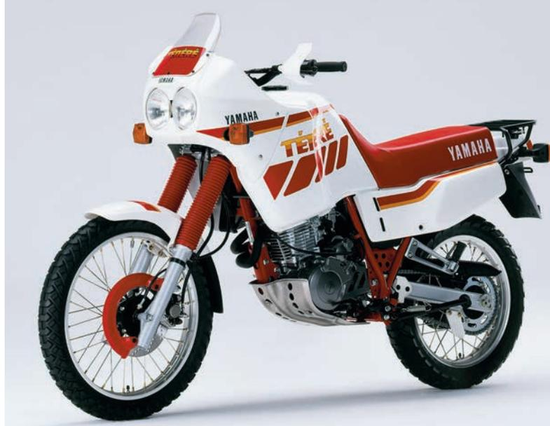
Größere Überarbeitungen erfuhr das Modell im Jahr 1986 mit dem Wechsel zur Ausführung 1VJ. Das Tankvolumen wurde auf 23 Liter, verringert, der Motor erhielt einen E-Starter und die Spitzenleistung wuchs von 43 auf 46 PS. Ein falsch platzierter Ölkühler sorgte in der Folge für zahlreiche Motorschäden, was nicht nur den Nimbus der Ténéré als unverwundliche Wüstenläuferin beschädigte, sondern das Image der großen Singles im Allgemeinen ruinierte.
