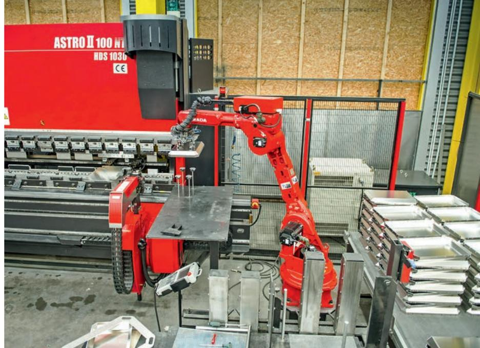
Automatische Übernahme von Teilen aus dem Abkantroboter.
