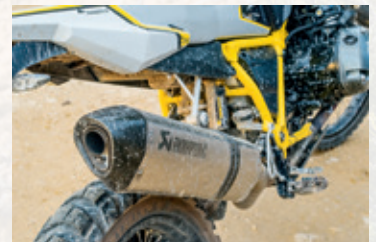
Original HP2-Schalldämpfer, leichter Akrapovic-Endtopf mit hohem Durchsatz. Č
