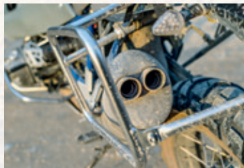
Original HP2-Schalldämpfer, leichter Akrapovic-Endtopf mit hohem Durchsatz. Č
