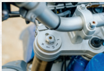
Einstellmöglichkeiten der HP2-Gabel und der Touratech Suspension Cartridge.
