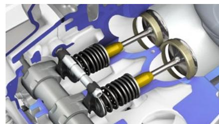
*Variable Nockenwelle mit eigenen Profilen für niedere und hohe Drehzahlen.*
