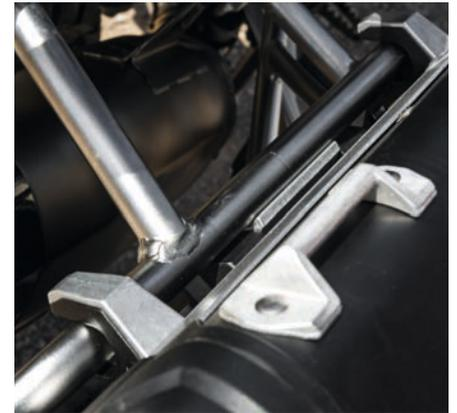
Arretierung der Mechanik durch den Handhebel.
