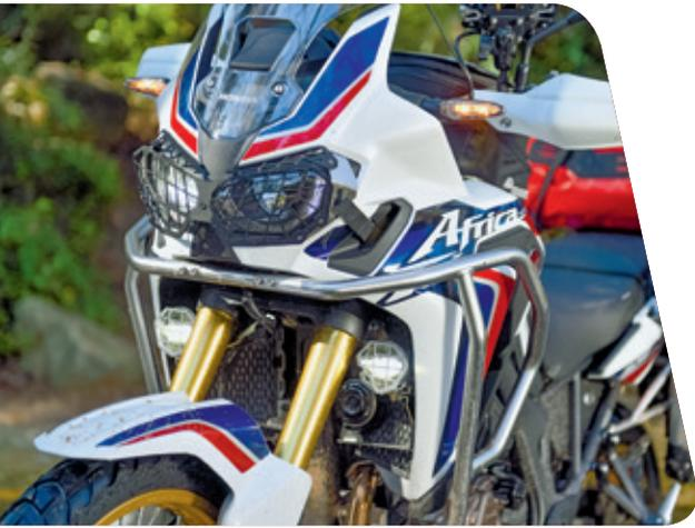
**Der Verkleidungsschutzbügel umrahmt die gesamte Front inklusive Radiatoren. Sowohl Haupt- als auch Zusatzscheinwerfer sind mit Gittern vor Steinschlag geschützt.**
