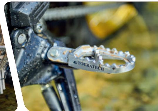
**Der robuste Motorschutz hält selbst heftigen Steinbeschuss von der Unterseite des Triebwerks ab. Der Edelstahlbügel schützt bei seitlichen Remplern aber auch bei Umfallen (l.) Die extrabreiten, gezackten Fußrasten verleihen sicheren Stand auch mit grobem Schuhwerk.**
