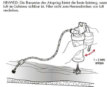
HINWEIS: Die Bauweise des Airspring bietet die beste Leistung, wenn Luft im Gehäuse sichtbar ist. Filter nicht zum Herausdrücken von Luft umdrehen.
