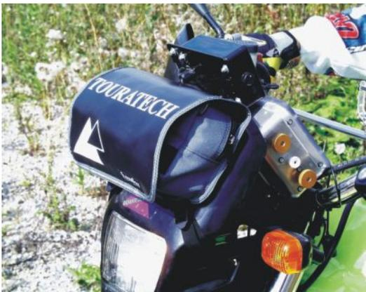
Für die Montage ist kein Werkzeug erforderlich. Die Tasche wird mit sechs Stahlhaken direkt an die Lampenmaske Ihrer Enduro geschnallt. Sie kann aber auch an vielen anderen Stellen am Motorrad befestigt werden.
