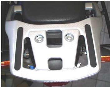
Als erstes müssen Sie nun den Träger V-Bügel oben montieren. Dieser verläuft über das Rahmenheck und wird anschließend mit der Gepäckbrücke und den originalen Schrauben befestigt. Setzen Sie bitte nur die beiden hinteren Schrauben der Gepäckbrücke an. Die beiden vorderen Schrauben werden im folgenden ersetzt.
