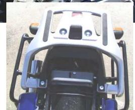
Die Miniblinker werden direkt an die Träger montiert, achten Sie hierbei bitte darauf, dass die Nut zur Gehäuseentwässerung auf der Unterseite des Blinkergehäuses liegt. Setzen Sie die originalen Leuchtmittel aus Ihren Honda Blinkern in die Miniblinker ein.
