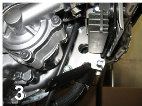
4.) Setzen Sie nun die rechte vordere Halterung an den Rahmen (Bild 1) und fixieren Sie diese mit der im Lieferumfang enthaltenen Schraube M10x80, zusammen mit einer U-Scheibe M10. Stecken Sie die Schraube entgegengesetzt der unteren Schraube, so dass Sie nachher die linke Halterung auch noch montieren können (Bild 3). Tauschen Sie die untere Schraube gegen die zweite im Lieferumfang enthaltene Schraube M10x80.
