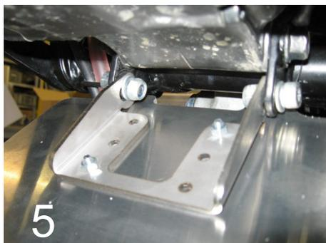
6.) Setzen Sie nun den Motorschutz im hinteren Bereich an die original Aufnahme. Verwenden Sie dazu die im Lieferumfang enthaltenen Schrauben M8x20, sowie je zwei U-Scheiben und je eine Mutter M8. Setzen Sie die Schrauben wie in Bild 5 gezeigt an die Aufnahmen und ziehen Sie diese an, allerdings noch nicht endfest.
