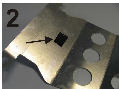
2. Die Gummierung der 25mm Klemmschellen entfernen! Den Streifen Rahmenschutzfolie halbieren, Position der Streifen durch provisorisches anlegen der Platte und der Schellen festlegen und anschließend jeweils wie in Bild 1 am linken und rechten Unterzug festkleben! Oberfläche vor dem Bekleben entfetten!
