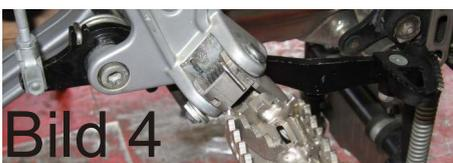
4.) Schrauben Sie nun Ihren neuen Bremshebel in umgekehrter Reihenfolge der Demontage an Ihre GS und verbinden Sie ihn mit dem Gabelkopf. Stellen Sie nun die Höhe der Schaltschraube ein, die den Bremslichtschalter F betätigt.
