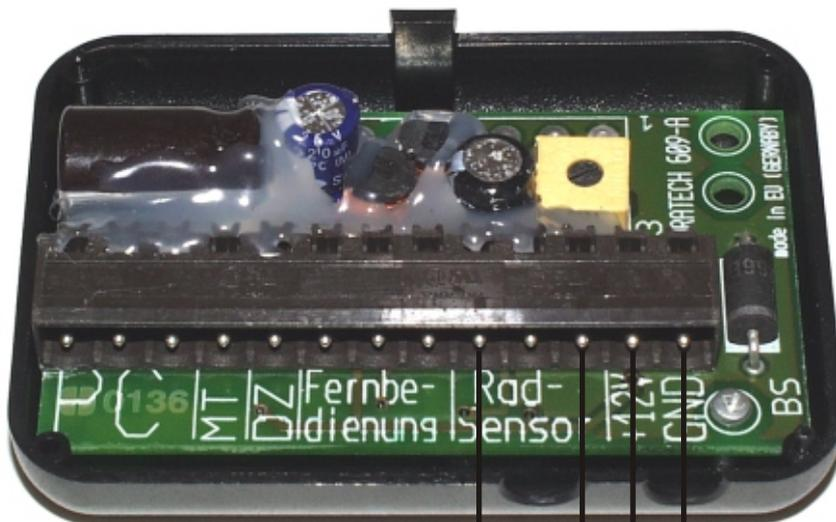
Verwenden Sie bitte zum Anschluss des Power Converters die beiliegenden Steckschraubklemmen (2pol für Eingang Power Converter; 3pol für Ausgang Power Converter) zusammen mit den vier Aderendhülsen.
