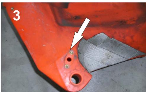
3. Benzinhähne demontieren und an den neuen Tankhälften montieren. Bild2+3
