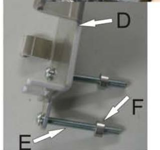
6.) Nun können Sie auch den Steuergeräthalter(D) montieren. Verwenden Sie dazu zwei Schrauben LiKo M6x60 (E), sowie die zwei Aluminium-Abstandsbolzen(F). (Reihenfolge des Zusammenbaus siehe Bild 8)
