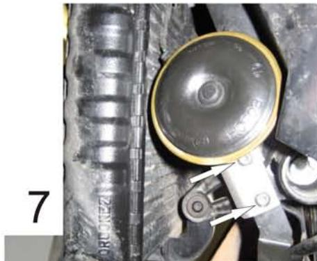
**HINWEIS:** Aufgrund von Fertigungstoleranzen, kann es dazu kommen, dass die Hupe an radiator den Kühler stößt. Biegen Sie in einem solchen Fall das Hupenverlegungsblech ein wenig von Hand nach, so dass die Hupe frei zwischen Rahmen und Kühler steht.
