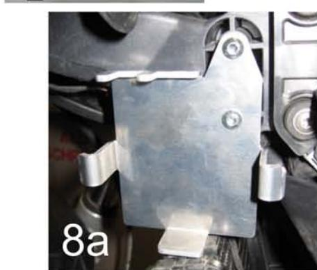
7.) Nun können sie das Steuergerät für den Xenon-Fernscheinwerfer einsetzen. Sichern Sie dieses mit dem O-Ring, welcher im Lieferumfang enthalten ist.
