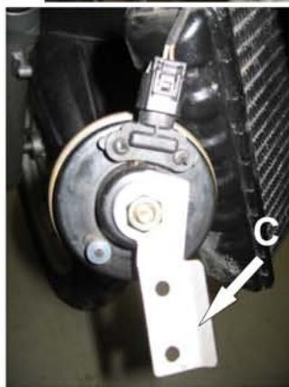
Demontieren Sie die Schraube an der linken unteren Kühleraufnahme und entfernen Sie diese. (Bild 7) Setzen Sie das Hupenverlegungsblech an die Stelle, wo Sie die Schraube entfernt haben und befestigen Sie es, wie in Bild 6 gezeigt, mit den im Lieferumfang enthaltenen LiFlaKo Schrauben M6x20 V2A.
