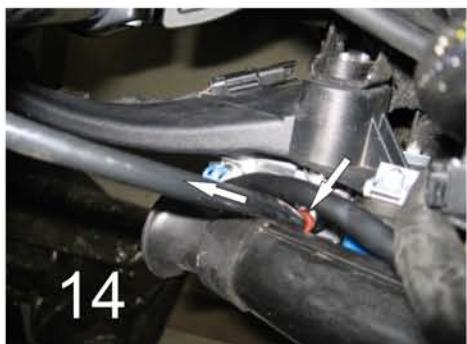
13.) Verlegen Sie nun das vom Steuergerät ausgehende Kabel, wie in Bild 14 gezeigt, hinter dem Lufteinlass nach oben, so dass Sie es, nachdem Sie die Seitenverkleidung wieder angebracht haben, über diese legen können. Schließen Sie den Scheinwerfer nun an. Setzen Sie den Stecker auf 11 Uhr in den Scheinwerfer und drehen Sie ihn im Uhrzeigersinn auf 12 Uhr. Achten Sie darauf, dass der Stecker richtig einrastet.
