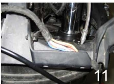
10.) Stellen Sie nun die Verbindung mit dem Fernlicht her. Dazu schneiden Sie bitte vorsichtig die schwarze Kabeltülle des original Kabelbaums auf, der im vorderen Bereich der Scheinwerfereinheit, unterhalb des Scheinwerfers, liegt (Bild 11).
