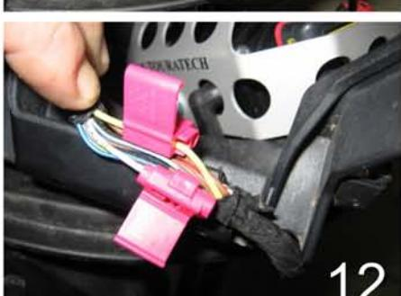
11.) Schließen Sie mit Hilfe des roten Kabelverbinder das weiße Kabel des Fernlichts, mit dem gelb-grauen Kabel des Zusatzscheinwerfers zusammen. (Bild 12) (in diesem Bild sind Zusatzscheinwerfer Nebel und Xenon angeschlossen) Kürzen Sie das gelbe Kabel des Zusatzscheinwerfers auf die nötige Länge ab.
