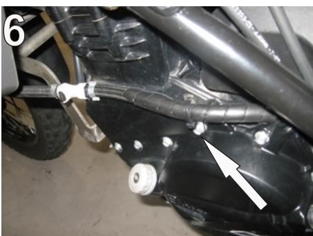
5. Verlegen Sie den Benzinschlauch auf der linken Seite wie auf Bild 6 dargestellt! Befestigen Sie hier ebenfalls 1 x Halteblech Benzinleitung mit einer Originalschraube am Kupplungsdeckel und sichern Sie den Schlauch mit einem der beigelegten Kabelbinder 290mm! Der Schlauch kann auch an der Innenseite des Halteblechs befestigt werden!
