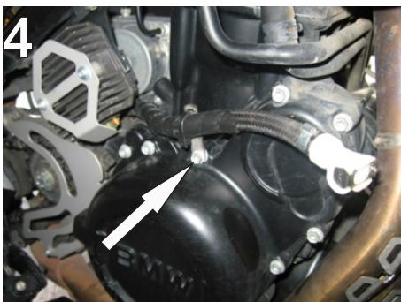
4. Verlegen Sie den Benzinschlauch auf der rechten Seite wie auf den Bildern 4 und 5 dargestellt! Den Schlauch dabei hinter dem Gleichrichter durchführen! Befestigen Sie 1 x Halteblech Benzinleitung mit einer Originalschraube am Lichtmaschinendeckel wie in Bild 4 dargestellt und sichern Sie den Schlauch mit einem der beigelegten 290mm Kabelbinder! Der Schlauch kann auch an der Innenseite des Halteblechs befestigt werden!
