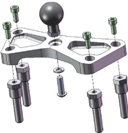
1. Ersetzen Sie die inneren vier Lenkerbefestigungsschrauben durch die vier beigelegten Spezialschrauben (Bild 1A). Bevor Sie diese jedoch festziehen, sollten Sie die anderen beiden Schrauben, die nicht ersetzt wurden lösen. Ziehen Sie nun alle Schrauben schrittweise zuerst leicht, anschließend mit einem Drehmoment von 19 Nm fest.
