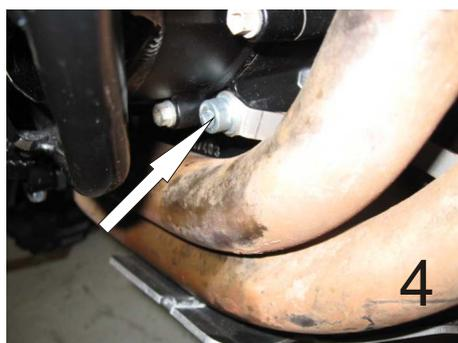
Die rechte Seite der Ölkühlerschutzkomponente wird ebenfalls mit einer Zylinderkopfschraube M8x20 und einer U-Scheibe M8 klein befestigt (Bild.4). Ziehen Sie nun die Schrauben fest. Schraubenanzugsmoment M10=20Nm, M8=20Nm beachten!!!
