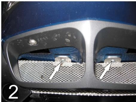
4.) Montieren Sie die Kunststoffverkleidung wieder in umgekehrter Reihenfolge der Demontage.
