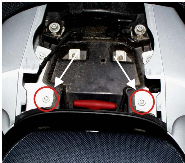
Tauschen Sie bitte die beiden markierten Schrauben auf der Innenseite des Gepäckbrückenfaches gegen die beiden beiliegenden Schrauben Linsenkopf M6x35 mit je einer U-Scheibe groß für M6. Sie müssen diese beiden Schrauben vor der weiteren Montage wieder richtig festziehen, da die Schrauben in eine Gewinde im Rahmenheck eingreifen, und später nicht mehr nachgezogen werden können.
