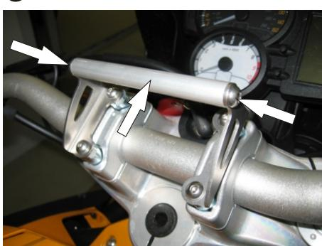
3.) Halterrohr zwischen Halter links und Halter rechts positionieren und mit 2 x Linsenkopfschraube M6x12 A2 verschrauben! (Bild3)
