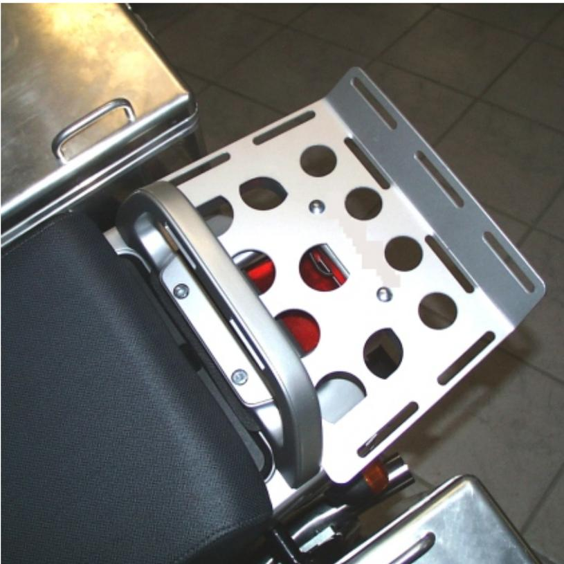
Demontieren Sie bitte zuerst den Haltegriff an Ihrer BMW R850/1100/1150 GS. Jetzt können Sie die Gepäckbrücken Verbreiterung auf den serienmäßigen Gepäckträger auflegen und zusammen mit dem Haltegriff mit den beiden originalen Schrauben befestigen. Die Gepäckbrücken Verbreiterung wird im hinteren Bereich zusätzlich mit den beiden Schrauben Flachrundkopf M5x16 mit je einer Mutter selbstsichernd M5 mit einer U-Scheibe M5 gesichert.
