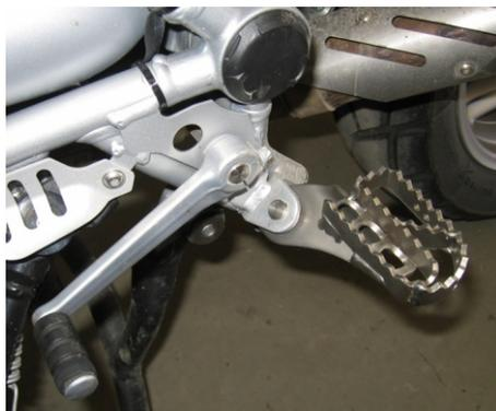
2.) Setzen Sie bitte die neuen Fußrasten analog zu den Originalen in die Fußrastenaufnahme mit Hülse, Feder und Bolzen ein. Die Sicherung erfolgt dann wiederum mit U-Scheibe und neuem Splint (bei Modellen ab R1200GS mit der vorhandenen Sicherungsscheibe).
