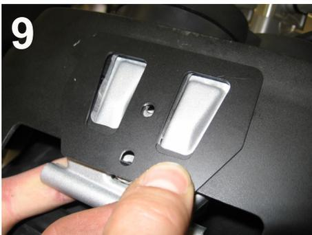
9. Distanzplatte wie in Bild 9 platzieren. Diese kann evtl. mit einem Tropfen Sekundenkleber fixiert werden, sofern Sie allein arbeiten und die Platte exakt positioniert ist!
