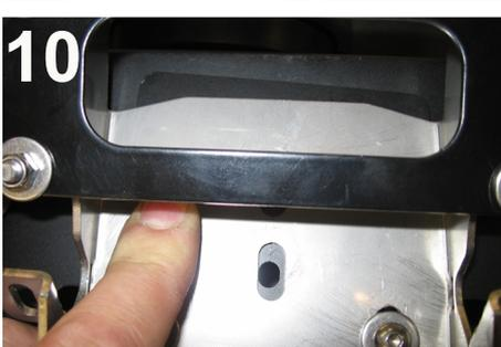
10. Den Verkleidungshalter wie in Bild 10 auf die Distanzplatte setzen. Den Haltewinkel vorne am Querrohr mit
