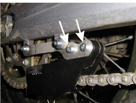
**Achtung! Die U-Scheibe wird wie in Bild 1 (siehe Markierung!) zwischen Edelstahl-Halter und dem Auge an der Schwinge platziert!**
