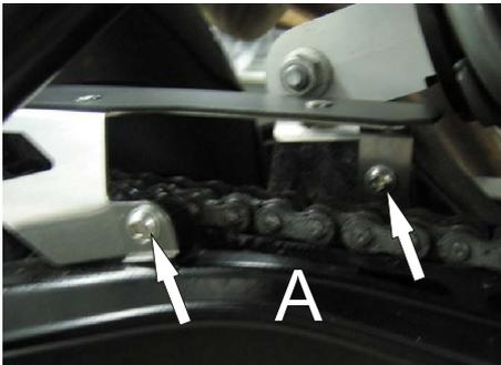
2. Bestücken Sie die drei im Lieferumfang enthaltenen M6 Linsenkopfschrauben mit jeweils einer U-Scheibe und legen diese zusammen mit der Distanzrolle neben Ihre Montagestelle. Reinigen Sie anschließend die Auflageflächen des Kettenschutzes.
