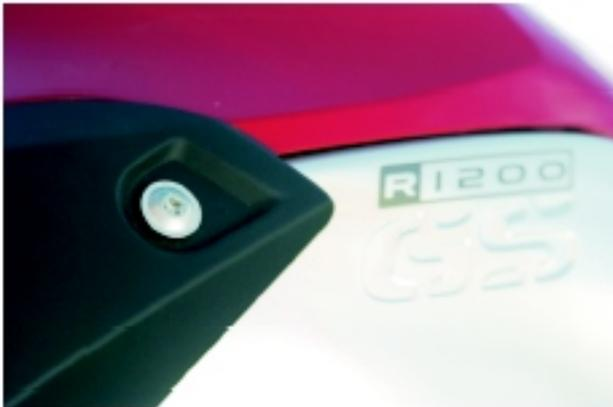
Eleganter Ersatz der Serienmäßigen Verschlüsse. Durch die Verwendung von Kreuzschlitz Köpfen wird wirkungsvoll das einfache Entwinden oder unerlaubte demontieren der Seitendeckel verhindert. Trotzdem bleibt die Wartungsfreundlichkeit erhalten.
