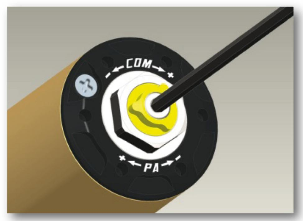
Tournez dans le sens des aiguilles d'une montre pour augmenter l'amortissement et dans le sens inverse des aiguilles d'une montre pour diminuer l'amortissement.
