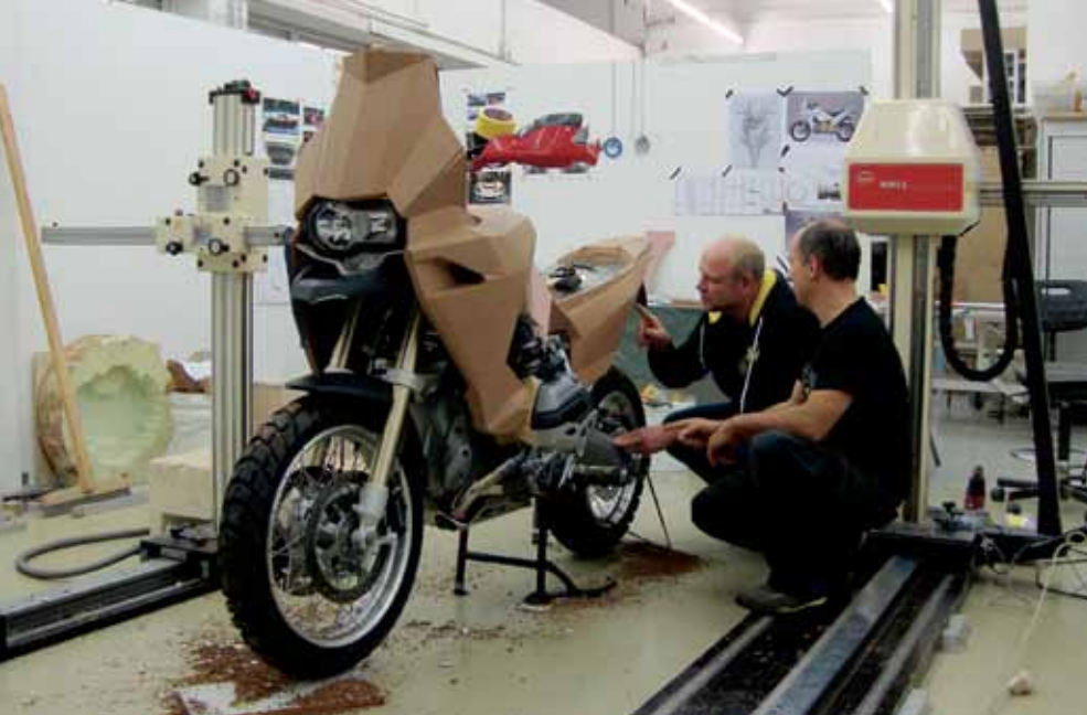
Feinabstimmung des Designs am Tonmodell (Touratech CEO Jochen Schanz und Dirk Bendl von TT-3D).
