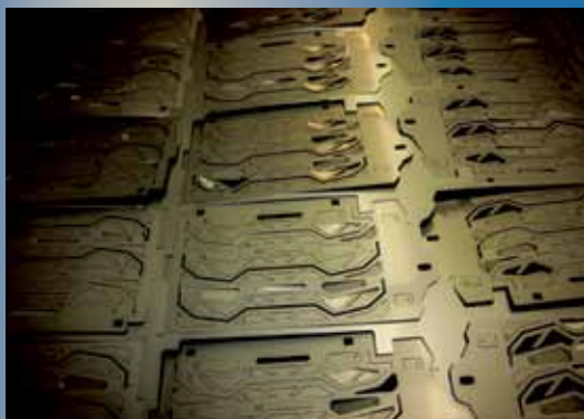
Die Laser-Maschine schneidet nicht nur sehr präzise, sie berechnet auch die optimale Ausnutzung des Materials.
