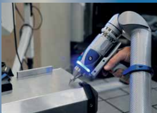
Mit dem 3D-Scanner kann die Geometrie auch komplexer Objekte schnell und genau für die elektronische Verarbeitung erfasst werden.
