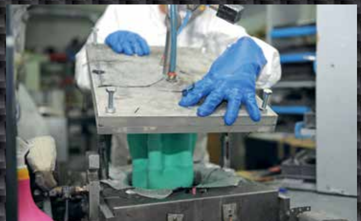
Laminieren Speziell geformte Zuschnitte von Kohlefasermatten unterschiedlicher Dichte werden in eine stählerne Form gelegt. Die Form gibt die äußere Kontur der Helmschale vor. Die Kohlefaserlagen werden mit Kunstharz übergossen. Nach dem Schließen der Form wird der Gummiballon mit Pressluft aufgeblasen und drückt die Struktur an die Wände der beheizbaren Form. Bei rund 75 Grad Hitze verbacken die Schichten des Kohlefaserwebes mit dem Kunstharz zu einem Laminat.
