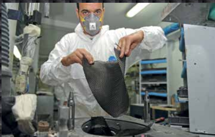
Laminieren Speziell geformte Zuschnitte von Kohlefasermatten unterschiedlicher Dichte werden in eine stählerne Form gelegt. Die Form gibt die äußere Kontur der Helmschale vor. Die Kohlefaserlagen werden mit Kunstharz übergossen. Nach dem Schließen der Form wird der Gummiballon mit Pressluft aufgeblasen und drückt die Struktur an die Wände der beheizbaren Form. Bei rund 75 Grad Hitze verbacken die Schichten des Kohlefaserwebes mit dem Kunstharz zu einem Laminat.
