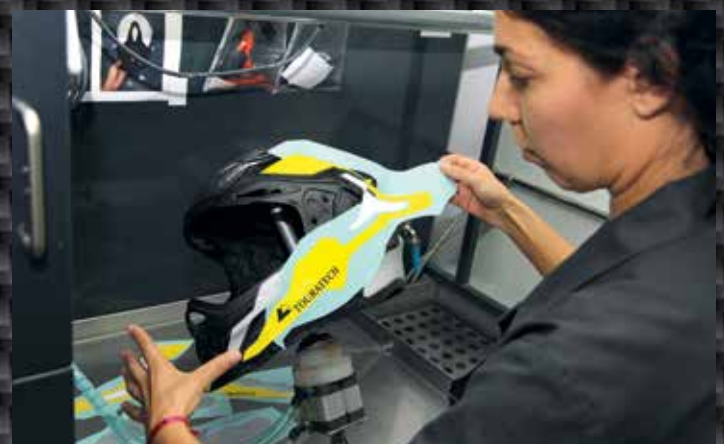
Dekor Die gefinishte Helmschale erhält ein Dekor. Eine ruhige Hand ist für das Zusammenfügen aus einzelnen Folienelementen erforderlich.
