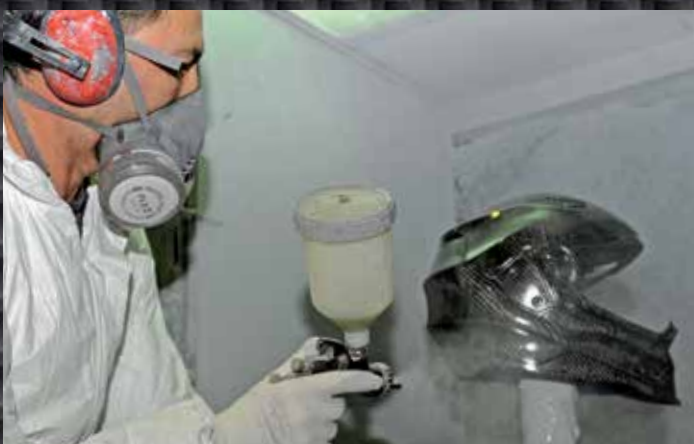
Schleifen und beschichten In mehreren Durchgängen werden Füller und Schutzlacke aufgebracht. Zwischen den Arbeitsgängen wird immer wieder geschliffen.
